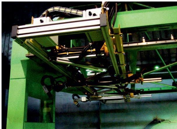
Система измерения геометрических параметров прокатных листов
