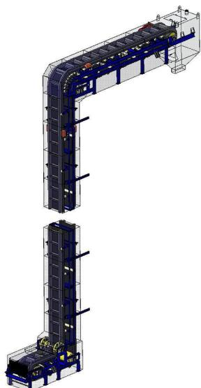
**Конвейер ленточный крутонаклонный КЛН
