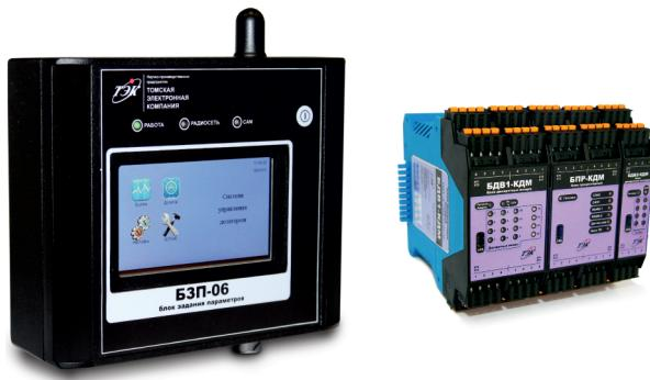
Блок задания параметров (БЗП-06) предназначен для отображения и задания параметров управления СДУ по интерфейсу CAN или беспроводному интерфейсу ZegBee.
