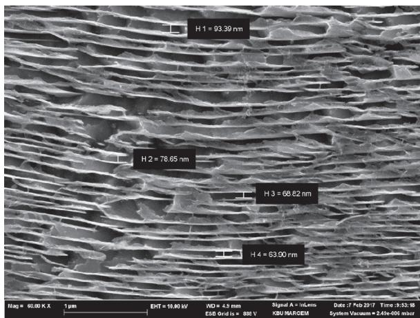
Микроструктура головки рельсов термообработанной по технологии ТЕС-ДТ
