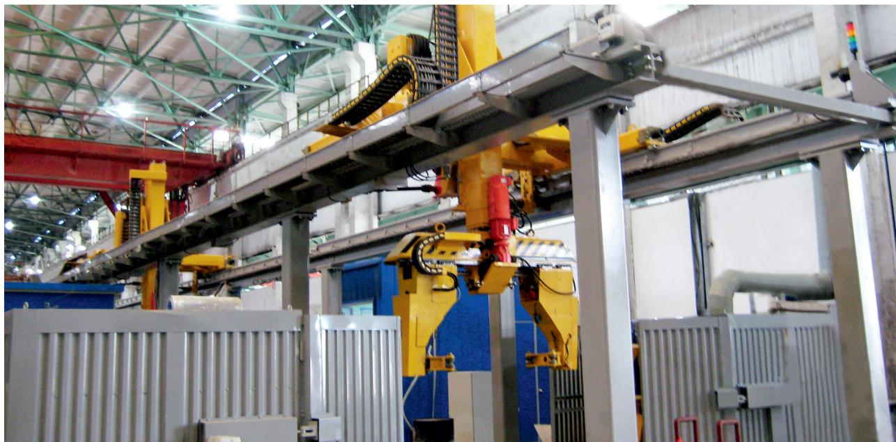
В ходе реализации данного проекта НПП «ТЭК» выполнил работы по проектированию, разработке конструкторской документации, изготовлению и поставке роботизированного транспортного комплекса (длиной 27,4 м), оборудования для загрузки и выгрузки колес на линию, транспортирования ж/д колес между технологическими установками. Также были сконструированы и изготовлены технологические установки подготовки поверхности ж/д колес для скоростных локомотивов. Была осуществлена пусконаладка всего оборудования.
