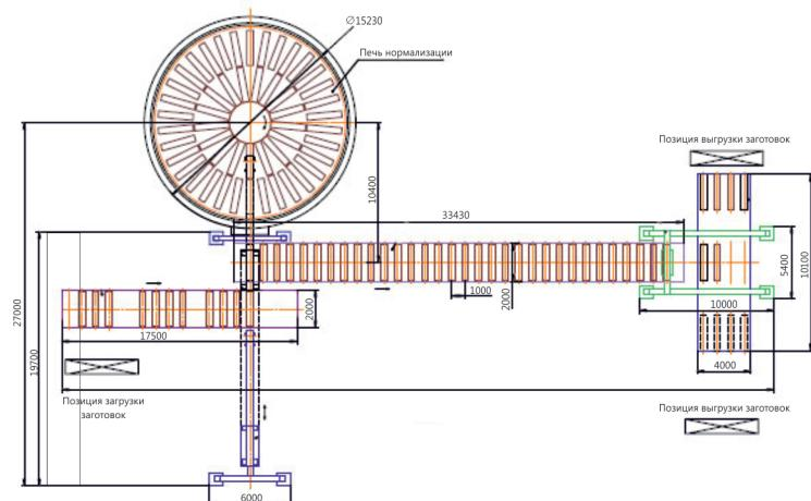
Заготовки, поступившие на участок нормализации, с помощью цехового подъемно-транспортного оборудования укладываются обслуживающим персоналом на базирующие элементы комплектовочной тележки. Комплектовочная тележка предназначена для помещения четырех заготовок. По окончании загрузки тележка перемещается к передающему столу. Передающий стол приподнимает заготовки, и комплектовочная тележка уходит на позицию загрузки.
