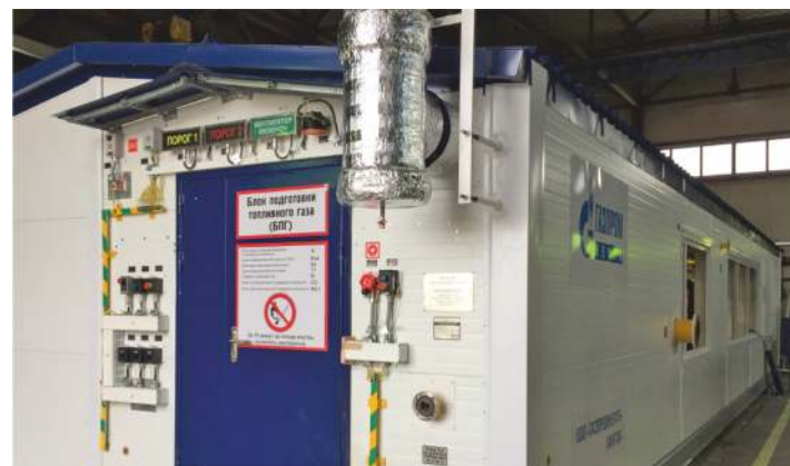
Блок подготовки топливного газа ООО «Газпромнефть-Хантос»
