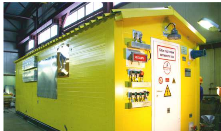
Блок подготовки топливного газа, Барсуковское м.р., ОАО «РН-Пурнефтегаз»
