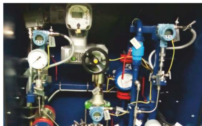
Блок дозирования реагента БДР-5 для Объекта «УКПГ. Сети внутриплощадочные Новопортовского НГКМ», ООО «Газпромнефть-Ямал»
