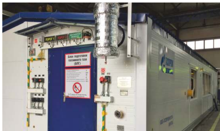
Блок подготовки топливного газа ООО «Газпромнефть-Хантос»
