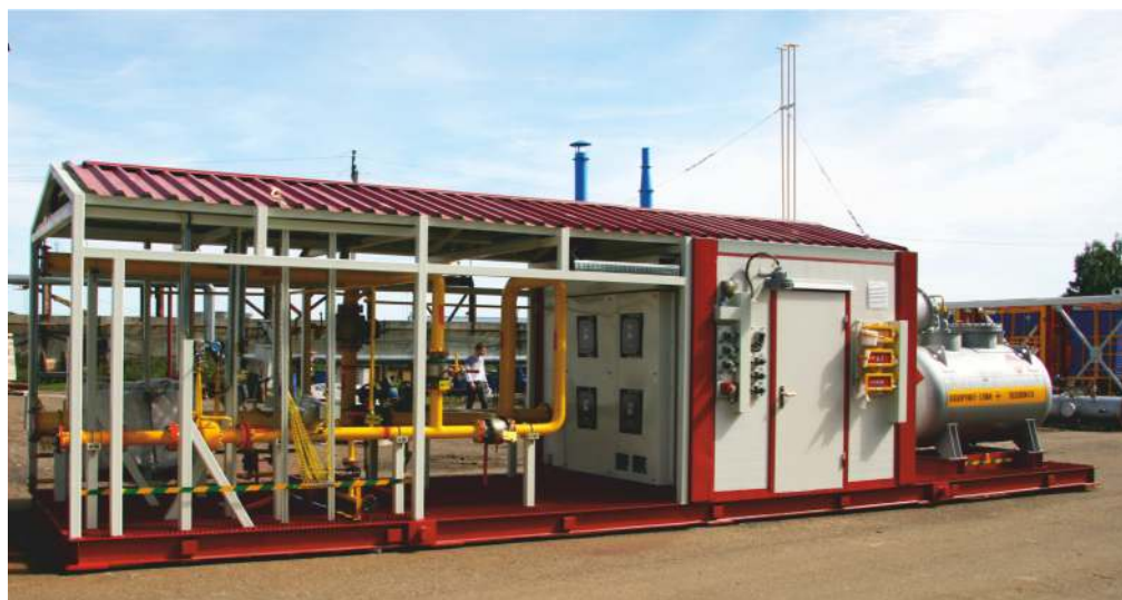
Установка осушки газа и регенерации триэтиленгликоля пос. Нижнесортымский ОАО «Сургутнефтегаз»
